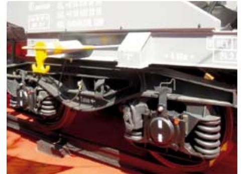
Seit der Freigabe durch die UIC und aufgrund der bevorstehenden EU-Emissionsvorschriften kommen beim Bau neuer Güterwagons K-Sohlen zum Einsatz. Dank bester Referenzen und überzeugender LCC-Argumente werden mehr und mehr K-Sohlen JURID 816M in den Bremsanlagen führender Wagonhersteller verbaut.
