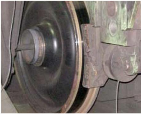
Abgesehen vom erfolgreichen Einsatz im Zugbetrieb wird die Produktqualität kontinuierlich auf den modernsten Anlagen des Jurid Entwicklungs- und Testzentrums geprüft und überwacht. Die Prüfergebnisse der unterschiedlichen Testprogramme bestätigen die Reibwertkonstanz und den geringen Verschleiß der Jurid Bremsklotzsohlen.
